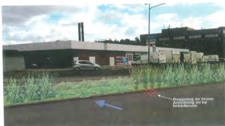
EFTER: UPPÖPPNING ASFALTÖ Uppöppning av asfaltö i miltrensare. Ersätts med avvattnings av körbanan via släpp i kansten med plan- tering och däck.
